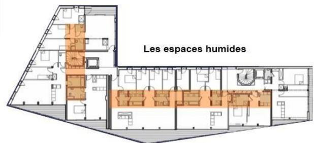
Fig. 95 : l'emplacement des sanitaires
