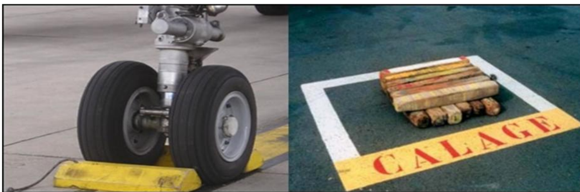
Figure III-4: Utilisation des cales (métallique et en bois)
