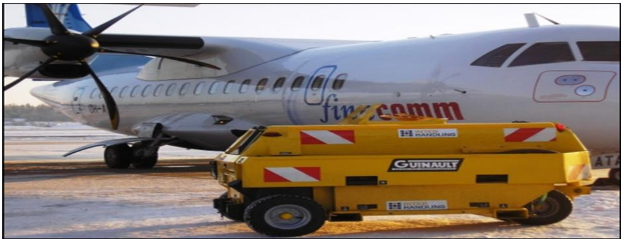
Figure III-6: Alimentation électrique de l'avion(GPU)
