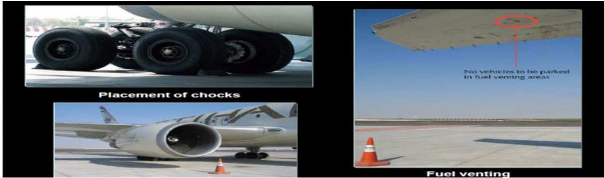
Figure III-3 : Utilisation des cônes de signalisation
