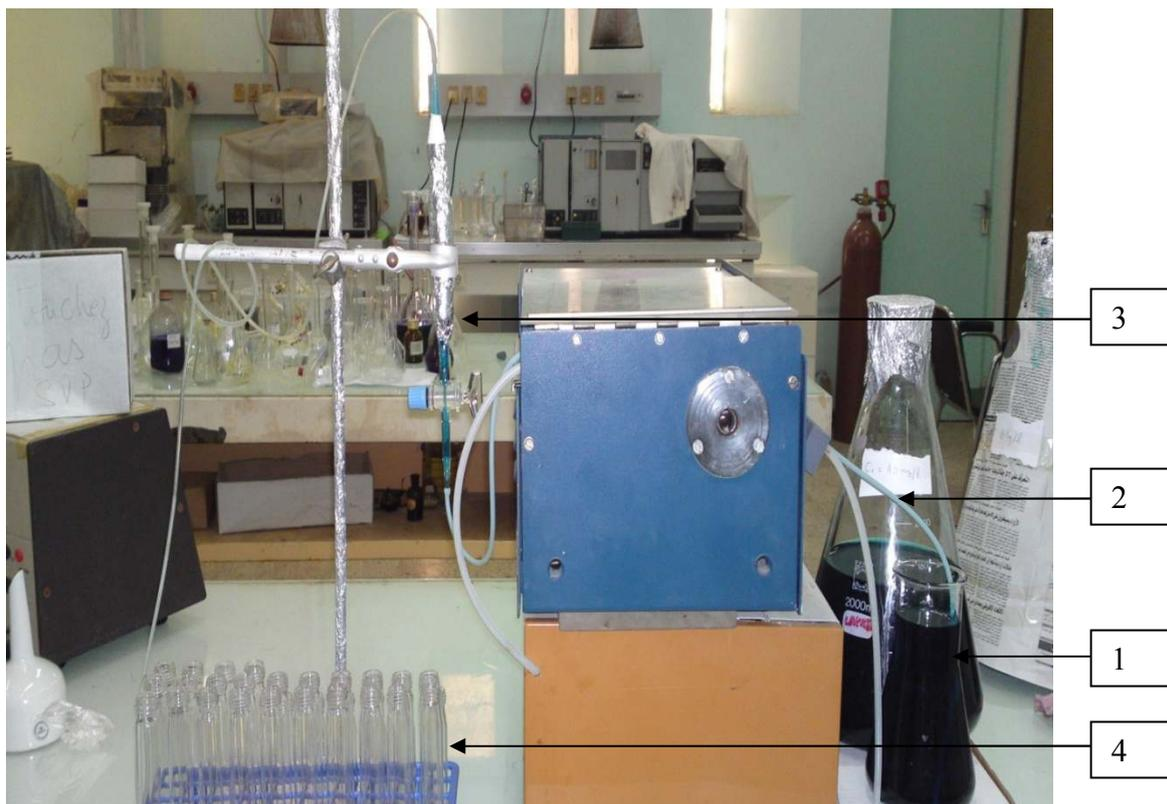
Figure II.3 : Schéma montrant le montage expérimental utilisé dans l'adsorption dynamique sur lit fixe du colorant basique vert malachite par Mg-Al-HDL.
