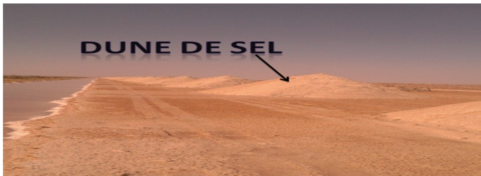
Figure II.19 : Photo montrant des dunes de sel obtenue par évaporation solaire de la saumure de chott (photo prise, 2013).
