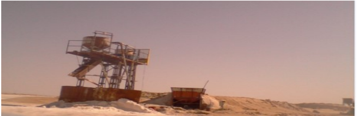
Figure II.20 : Photo montrant le lavage de sel par le brassage dynamique dans les chotts D’El Oued, (photo prise, 2013).
