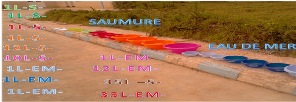
Figure IV .1 :Photo montrant le séchage naturel de la saumure et l'eau de mer (photo prise, 2013).
