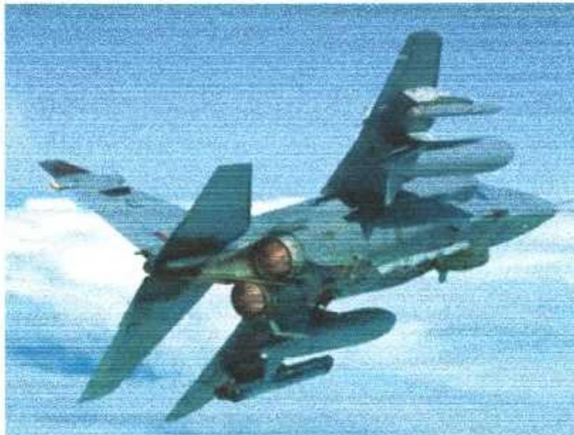
**Fig.1.6 Tuyères d'un avion de combat**
