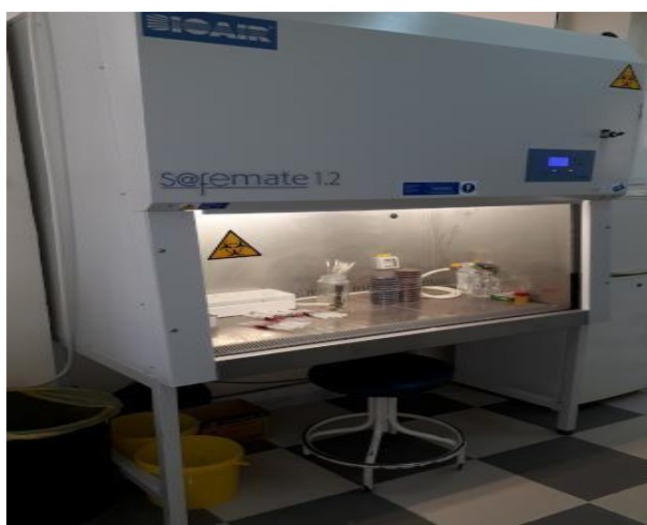
Figure 3 : Poste de sécurité microbiologique classe II.
