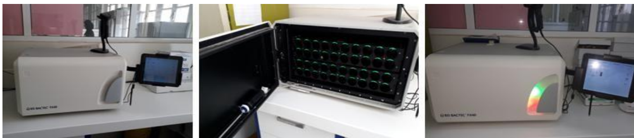
Figure 1 : Bactec (automate d'incubation et de surveillance des hémocultures)
