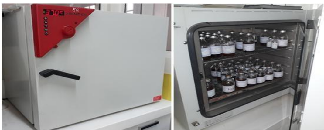
Figure 2 : Etuve d'incubation des flacons d'hémoculture (37°C)
