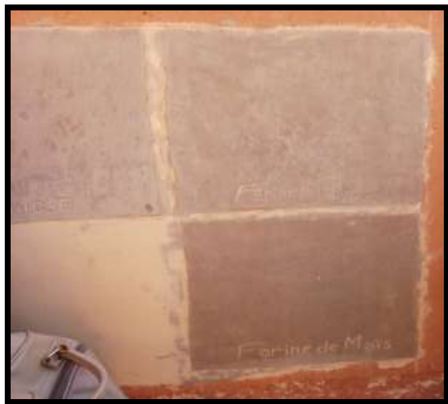
Essaie d'enduit qui date de 2014 Dim: tableaux 25 x 25 cm (projeté sur le mur) Sans stabilisant
