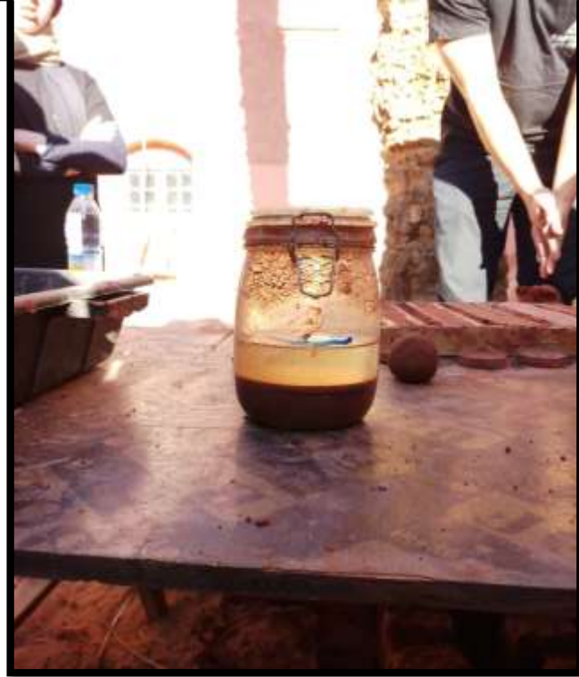
Fig.34: teste pour connaitre la nature des compostant de l'argile .
