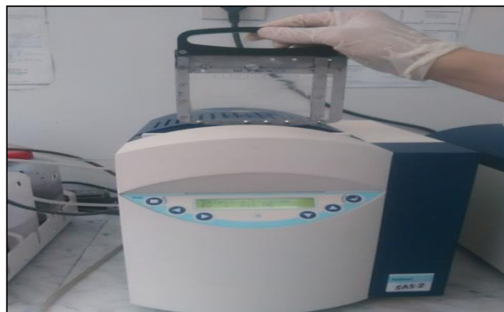
Figure 14: Fixation du gel dans l'appareil de coloration (Helena SAS 2).
