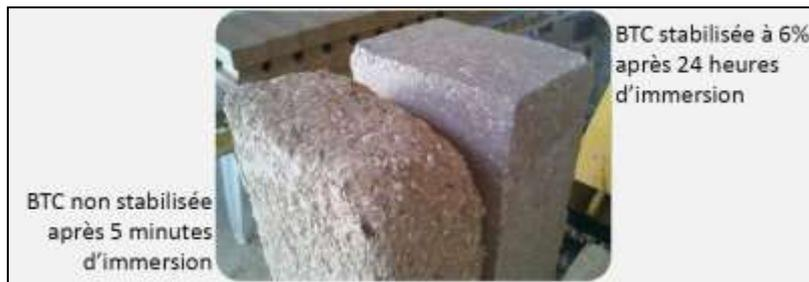
Figure N°71 : différence entre un BTC stabilisée et non stabilisée
