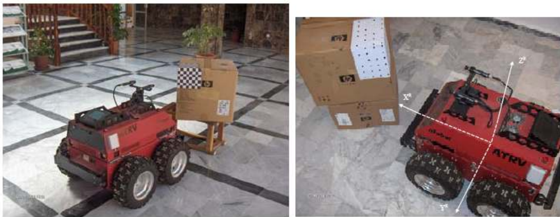
Figure 3.13 Calibrage du banc stéréoscopique du robot mobile ATRV2.
