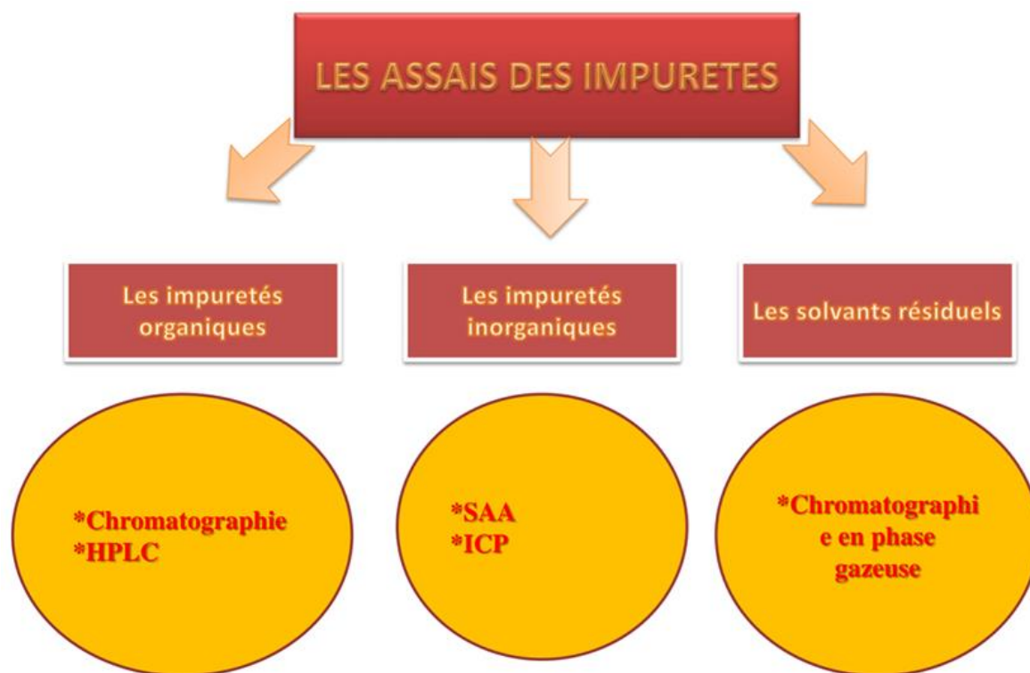
Figure 5 : Schéma des essais des impuretés
