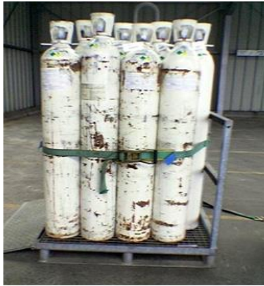
Figure 25: Bouteilles détériorées stockées à l'extérieur.
