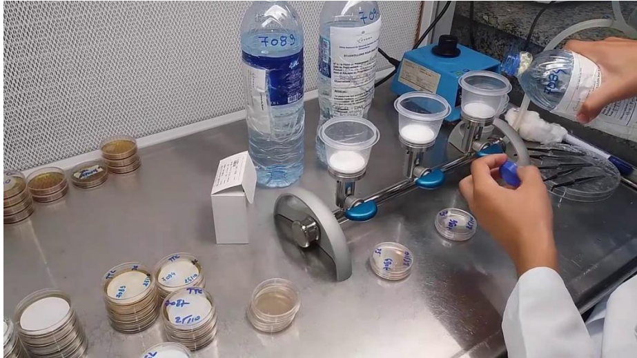
Figure 45 : installation de filtration sur membrane.
