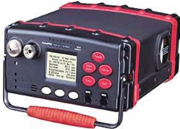
Figure N° 21 : Analyseur de BTEX GC portable PetroPRO de Photovac (Badjagbo.K, 2009)
