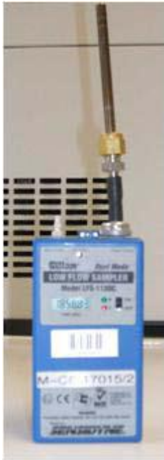
Système de prélèvement portatif fonctionnant sur batterie (autonomie 8 heures)
