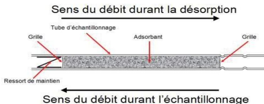
Figure N°24 : Orientation des débits de prélèvement et de désorption. (Maret.L, 2013)
