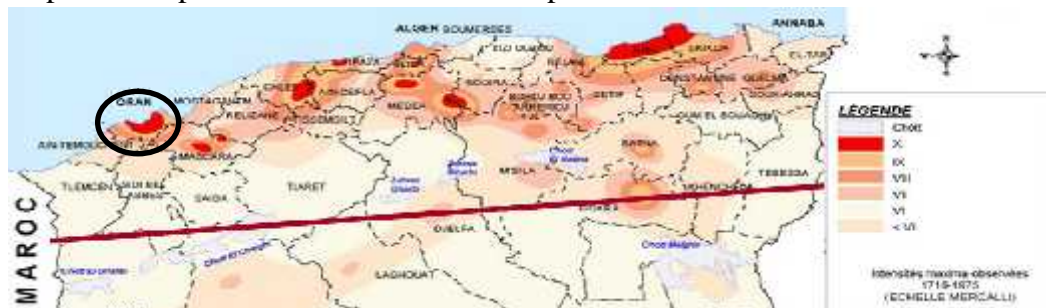
Figure 24 Carte 17 : Sismicité du Nord Algérien (le site d'intervention est inclus dans la zone à forte et à moyenne sismicité)
