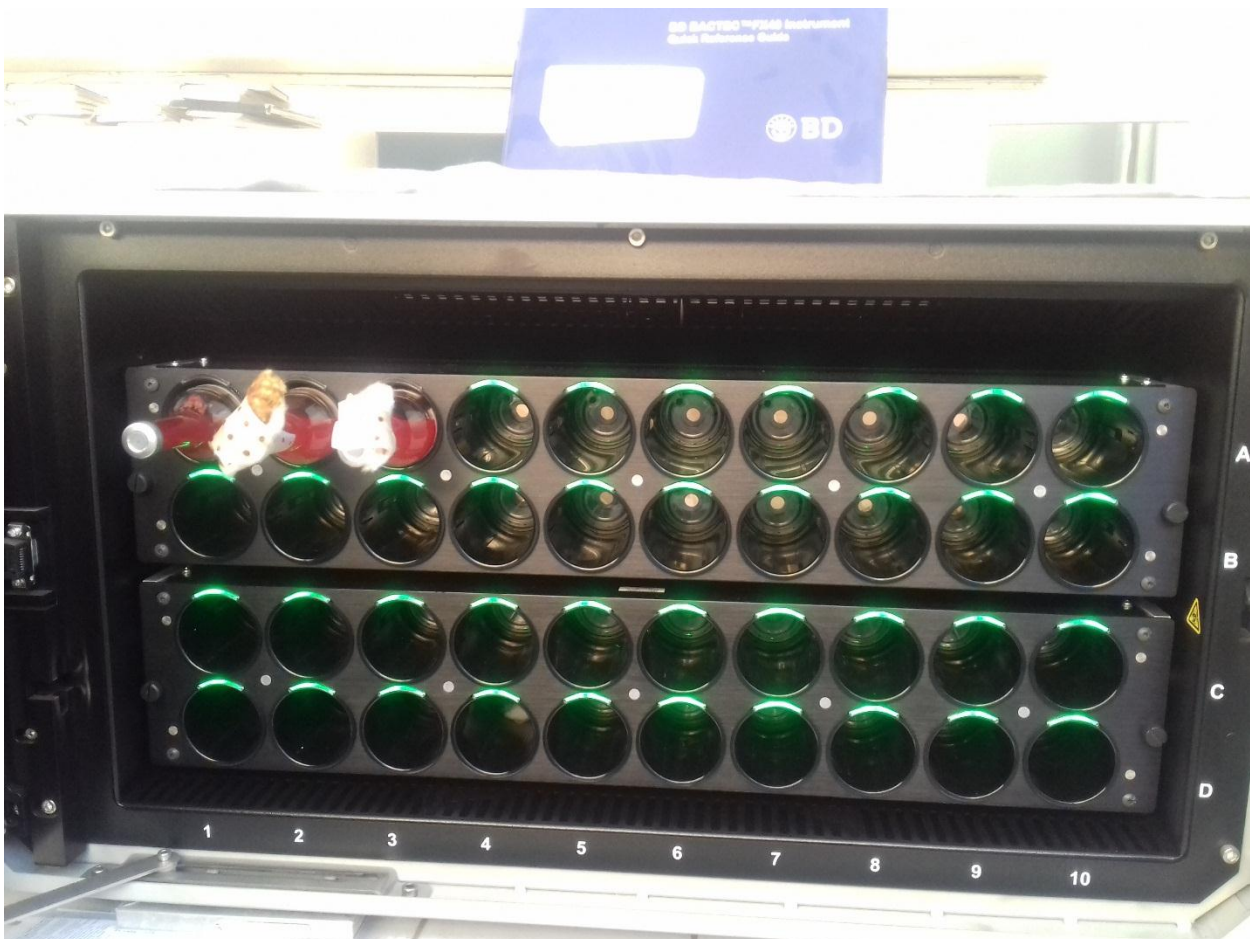
Figure 12 : Système BACTEC pour la détection automatisée
