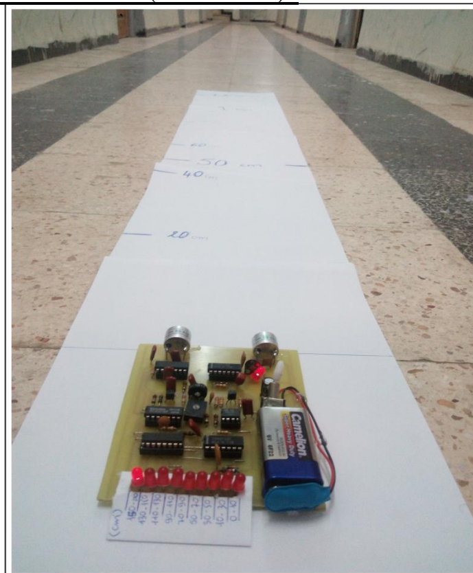
Figure III. 42 : Radar en fonction sans cible (1 led allumé)
