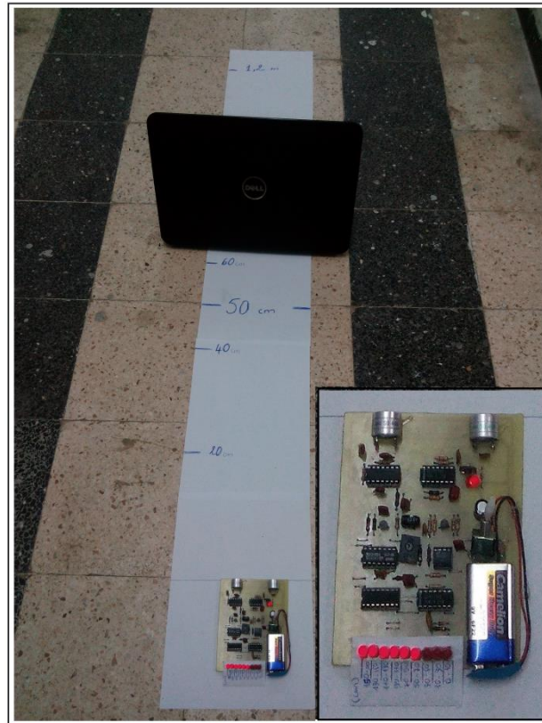
Figure III. 45 : Cible à 60 cm (6 led allumé)
