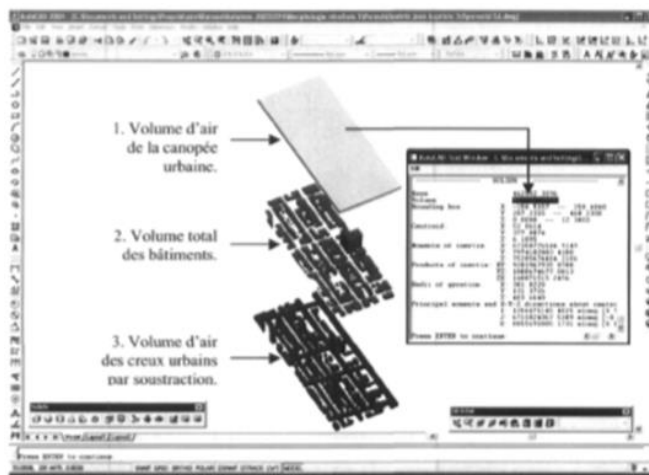
Figure 18: Interface du logiciel Autocad 2004, présentant la procédure de calcul de la porosité urbaine. Une application pour le périmètre de calcul C (Quartier).
