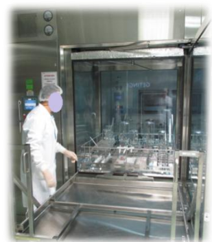
Figure 22: COP, nettoyage de verrerie dans une machine à laver [42]
