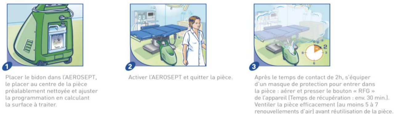
Figure 52 : Mode de l'emploi de l'ANIOS DVA HPH dans un générateur d'aérosol Aérosept
