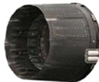
Figure I.14 : Tuyère à section variable
