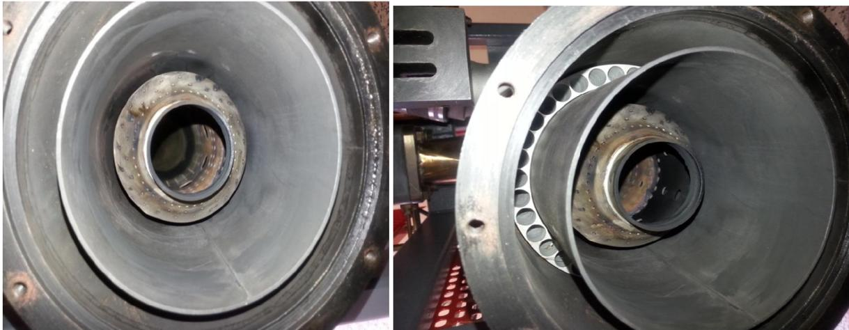
**Figure I.21** :Chambre de combustion du banc d'essai
