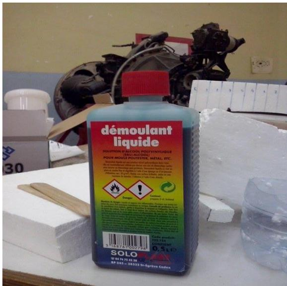
**Figure (IV-14):** le démoulant liquide
