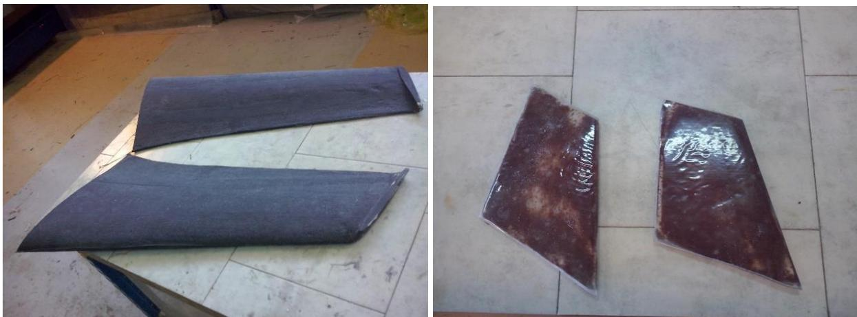
**Figure (IV-25) :** Applications des différents tissus pour les ailes et les winglets.
