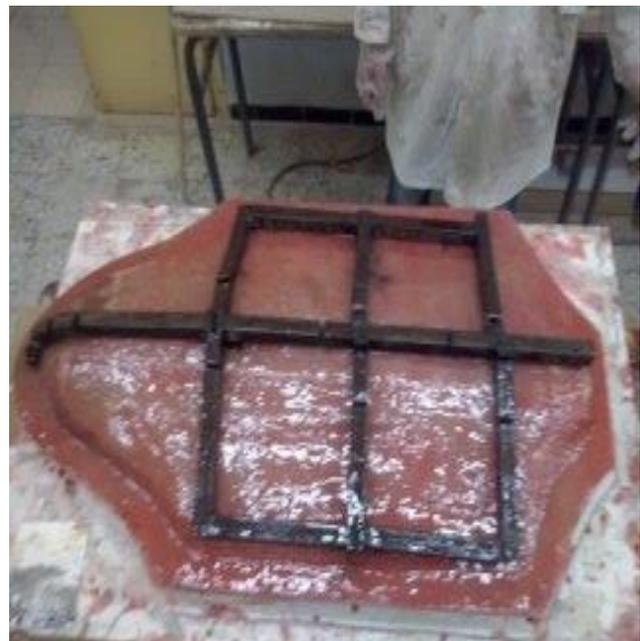
**Figure (IV-20) : la réalisation de deuxième partie du moule**
