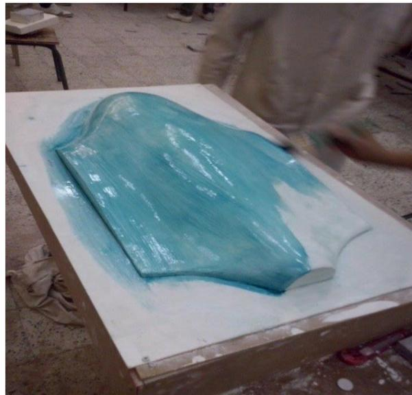
**Figure (IV -15):** Application du démoulant liquide.
