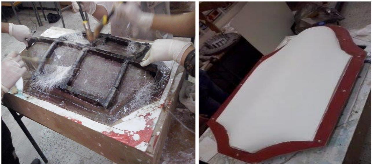
**Figure (IV-18) : renforcement du moule****Figure (IV-19) : première partie du moule**
