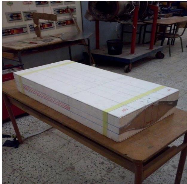
**Figure (IV-7) :** Découpe de la vue de face de fuselage.
