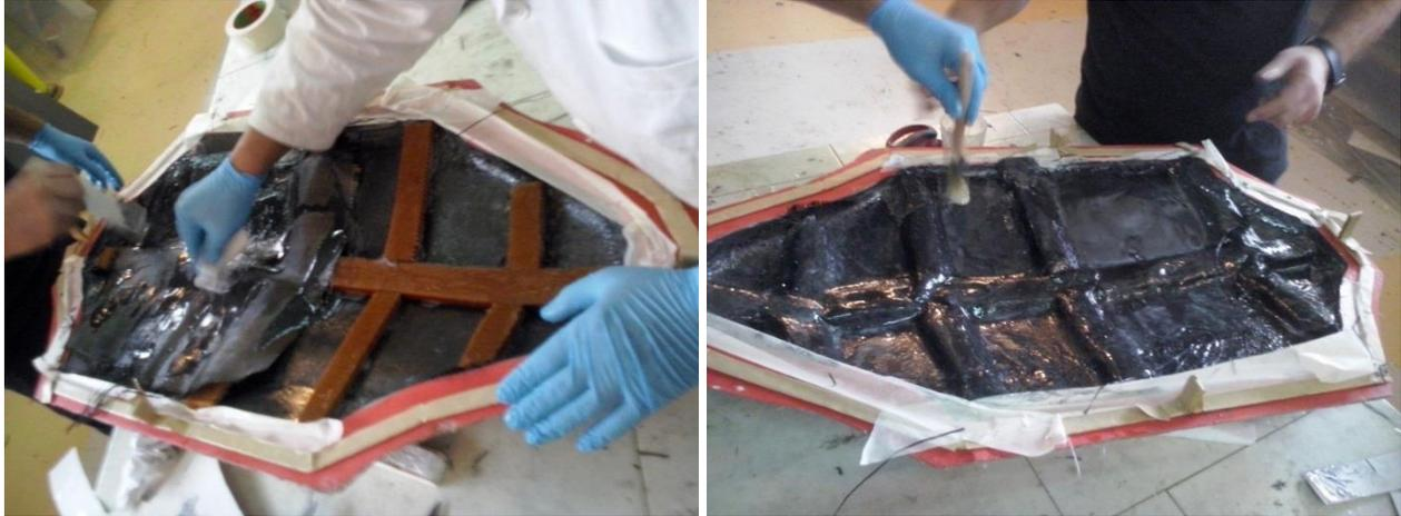
**Figure (IV-26) :** Squelette de renfort de fuselage.
