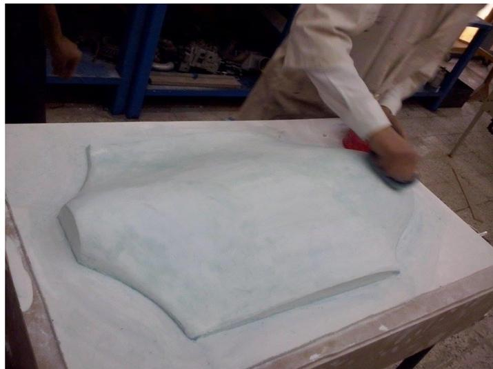
**Figure (IV -12) :** la sire de démoulage      **Figure (IV -13):** Application de la sire de démoulage.
