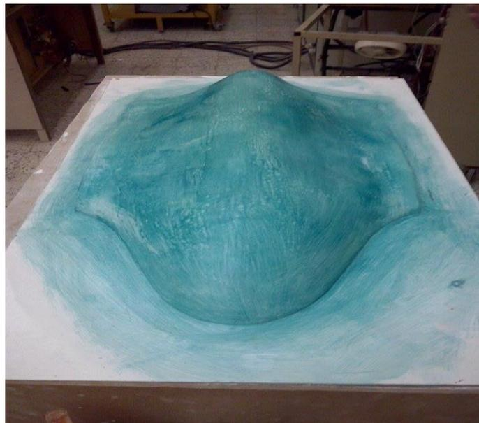
**Figure (IV-16):** la forme final du model après l'application de PVA et le démoulant liquide
