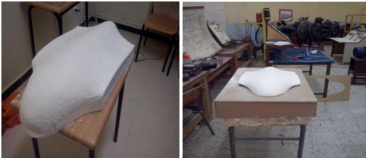
**Figure (IV-10) :** Protection de modèle contre résine (avant/après ponçage)
