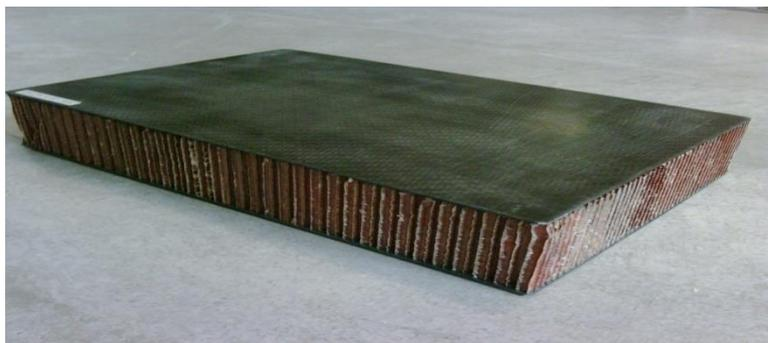
**Figure (IV-6):** Sandwich en carbone.
