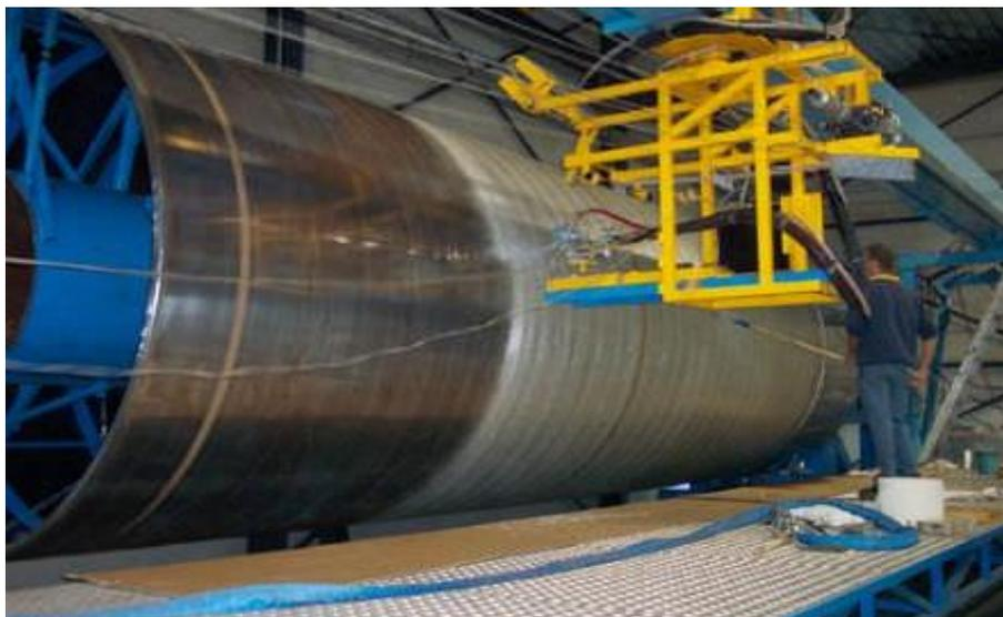
Figure (IV-5) : Machine à enroulement filamentaire.
