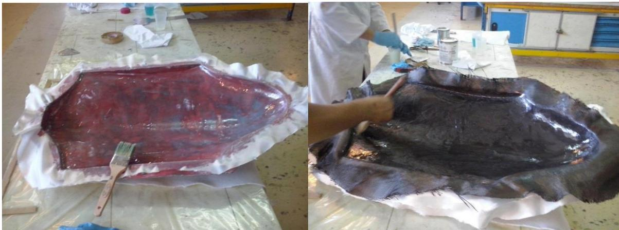
**Figure (IV-23) :** Applications des différents tissus pour le moulage.
