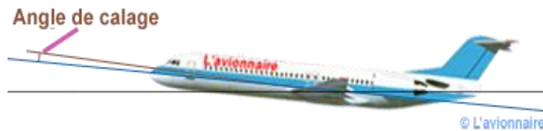
Figure II.7 : Angle de calage d'un profil.
