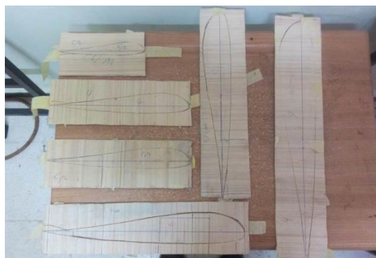
Figure VI.14 : construction des gabariés en bois.
