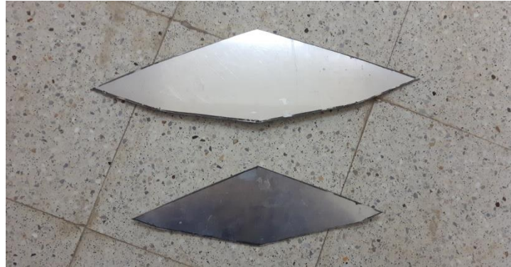
Figure VI.22 : Longerons avant et arrière de fuselage.
