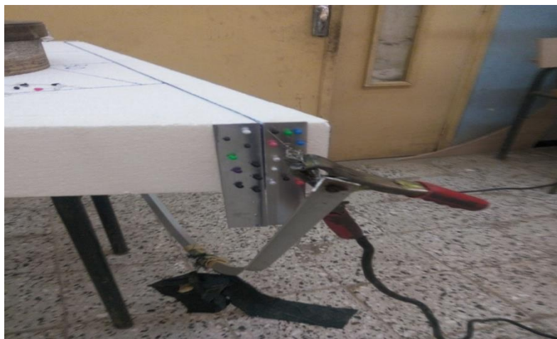
Figure VI.5 : Méthode de découpage à fil chaud.
