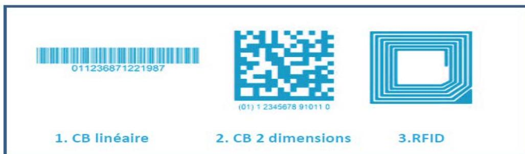
Figure (11) : Représentation des différents codes-barres [50]
