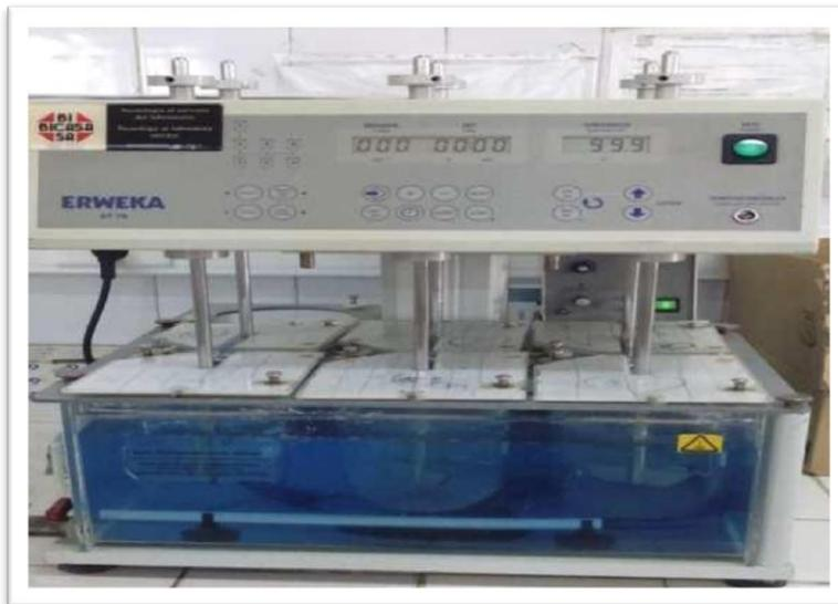
**Figure 7.2 : Dissolu test ERWEKA DT 70/PHILIPS (A palette).**
