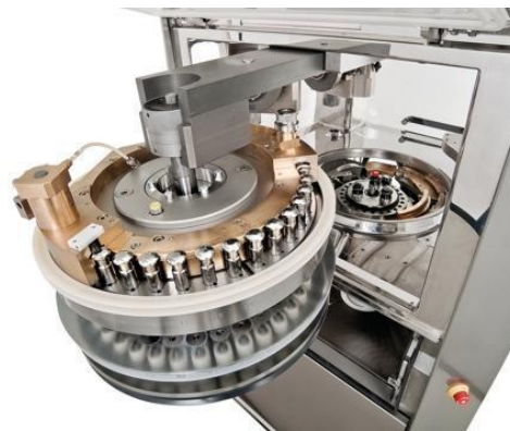
Figure 5: vue réelle d'une tourelle de machine à comprimer rotative
