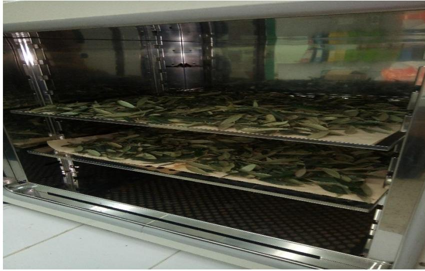
**Figure 14 :** Séchage de feuilles d'olivier dans une étuve de séchage
