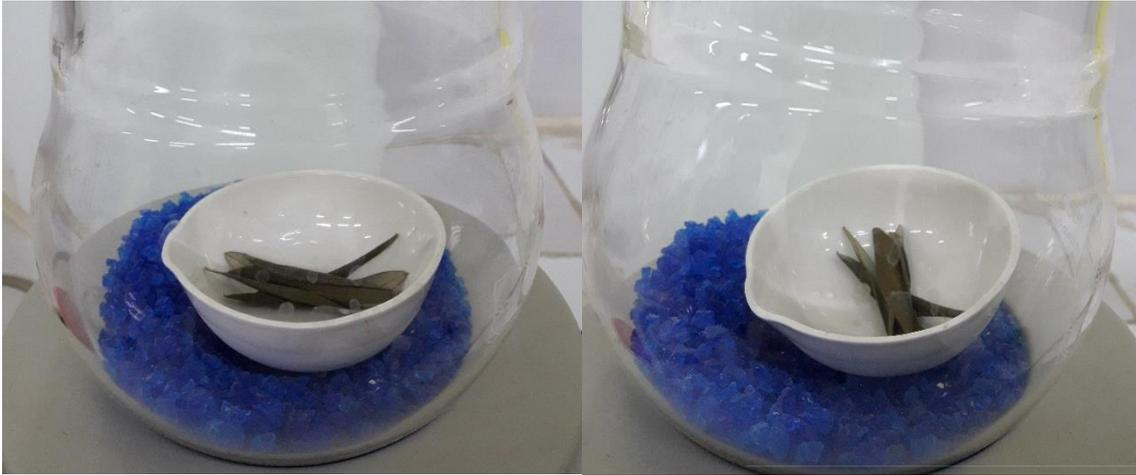
**Figure 22** : Les feuilles d'olivier sauvage et cultivé après 2h de séchage dans un dessiccateur équipé de gel de silice
