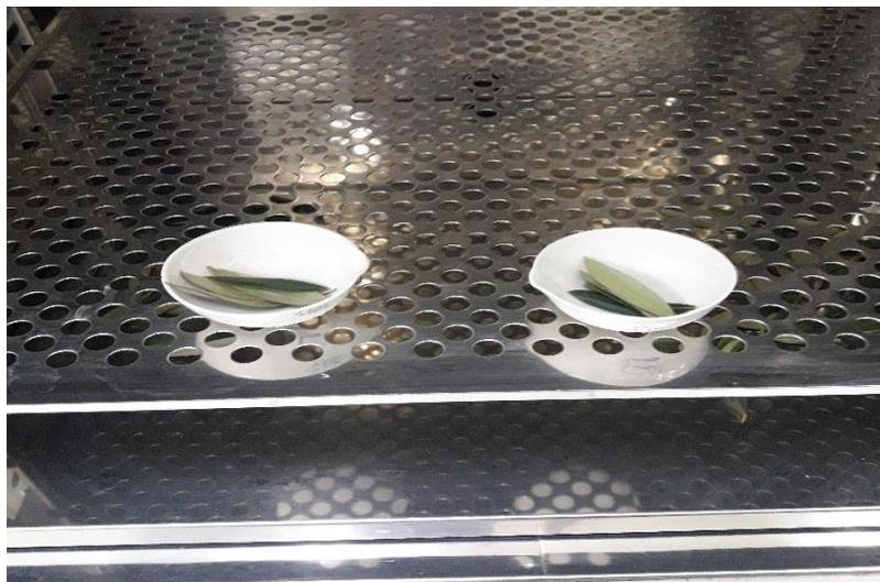
**Figure 21** : mise en évidence des feuilles dans l'étuve à 105°C
