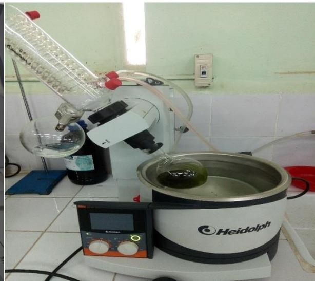
**Figure 26 :** éliminations du méthanol avec rota vapeur
