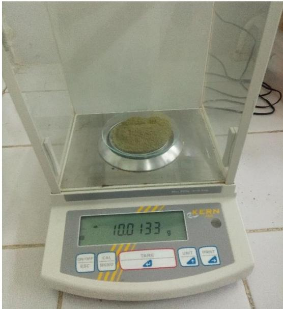
**Figure 23 :** La pesée de 10g de poudre à l'aide d'une balance analytique
