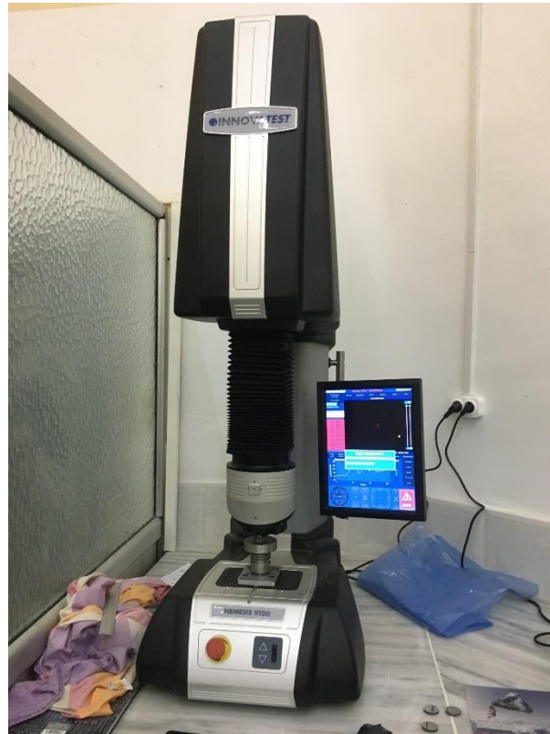
Figure 08: machine de dureté nemesis 9100
