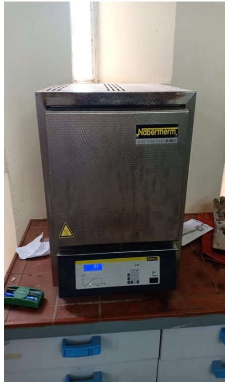
Figure -6 : Four utiliser en traitement thermique
