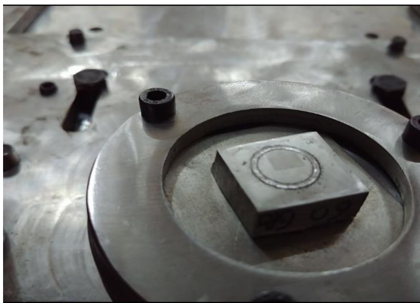
Figure IV.25 : l'empreinte de bille après un essai de tribologie.
