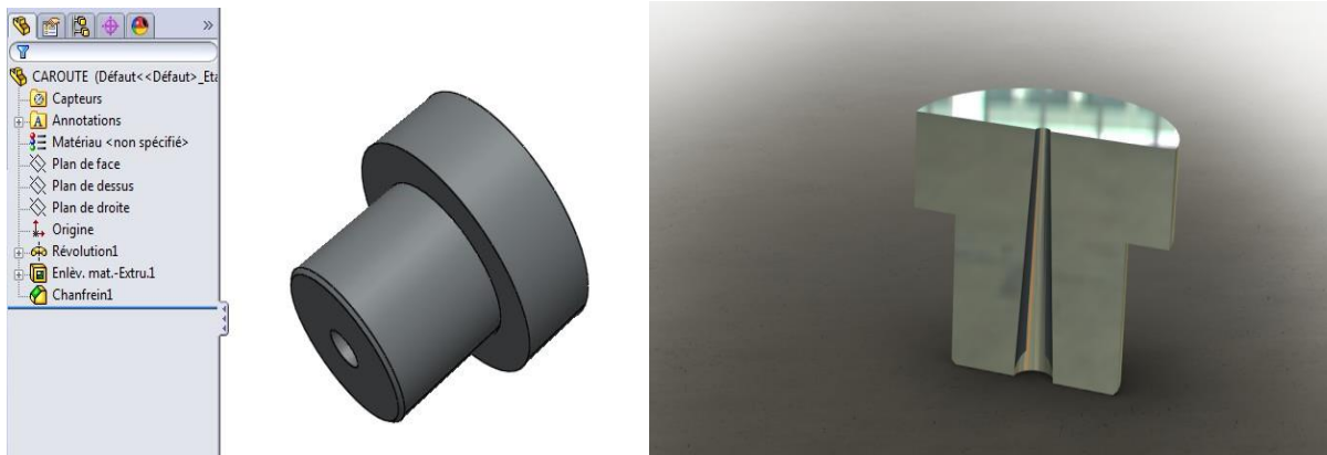
49Fig. (III. 3) : La buse d'injection
