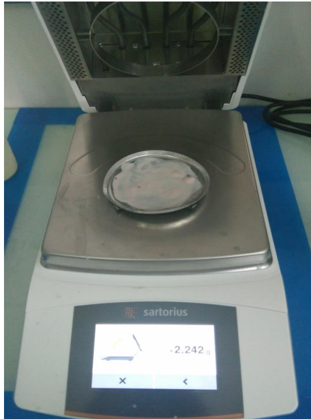
Figure 4 : Mettre la coupelle dans le dessiccateur
