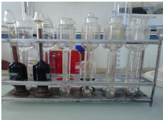
Figure 5: Détermination de la teneur en matière grasse.
