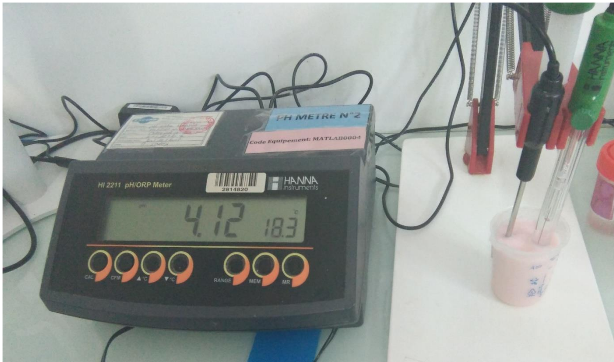
Figure 3 : Détermination du pH par le pH-mètre.
