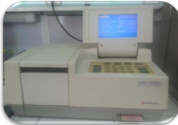
**Figure 25 : Spectrophotomètre UV-visible utilisé**
