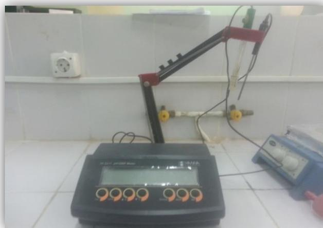
Figure 23 : pH-mètre utilisé pour détermination du pH de la surface
