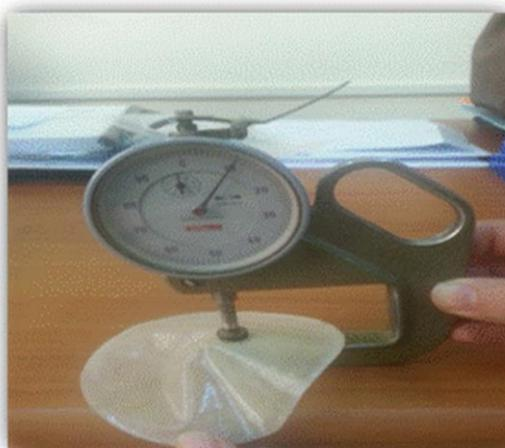
**Figure 22 : Détermination de l'épaisseur par un micromètre.**
