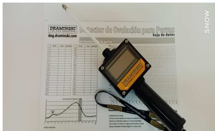
Figure 26 : photographie personnelle montrant l'appareil qui mesure la résistivité vaginale (® CRFC/GN de Bâinem)
