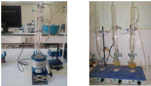
Figure 27 : photos prise de l'extraction par soxhlet lors de la première étude
