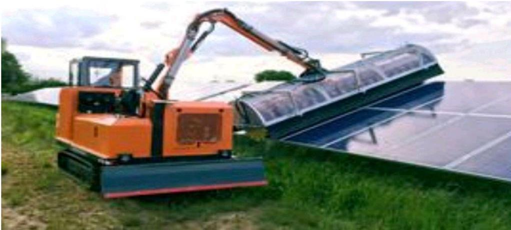
**Figure 3. II :** nettoyage semi-automatique de panneau photovoltaïque
