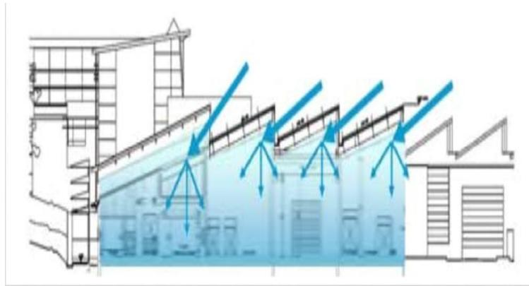
Figure 27: le principe des sheds. (source : <http://www.energieplus-lesite.be> )
