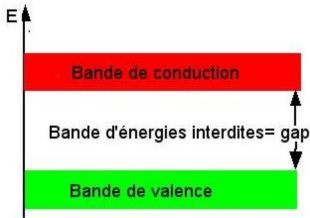
Figure I.7: Schéma de bande d'énergie d'un semi-conducteur
