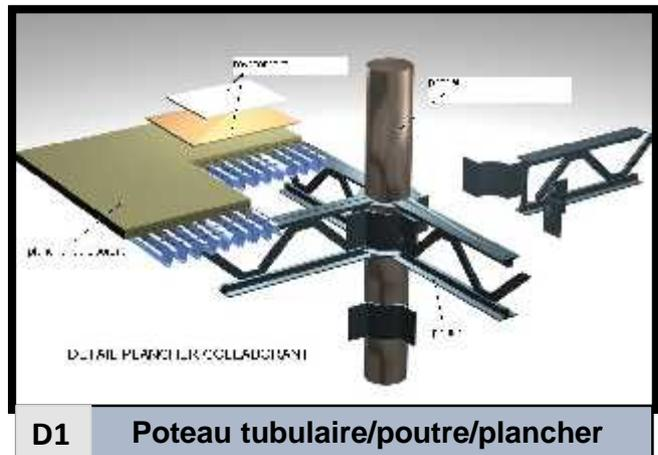
**D1 Poteau tubulaire/poutre/plancher**
