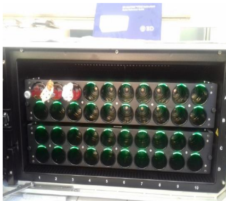
Figure 4 : Système BACTEC pour la détection automatisée
