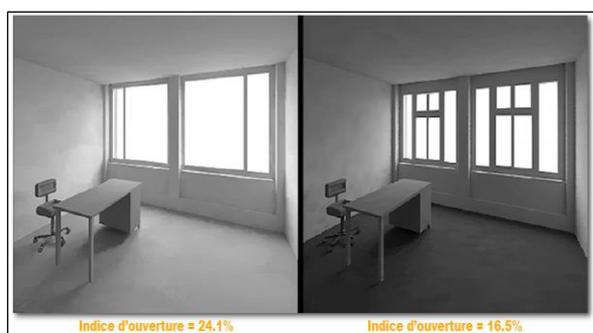
**Figure 95** : Résultat d'éclairément obtenu sous un indice d'ouverture variable ; **Source** : B. Paule, 2007.
