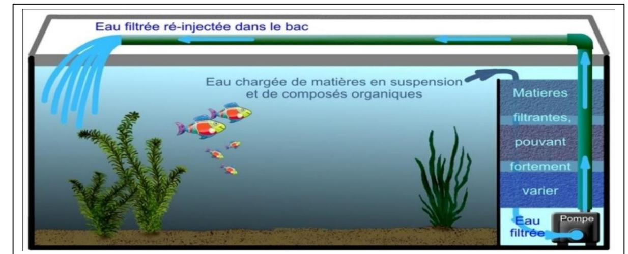
Figure 147 : Système de filtration de l'eau de l'aquarium ; Source : Site Web ; AQUABASES,2006
