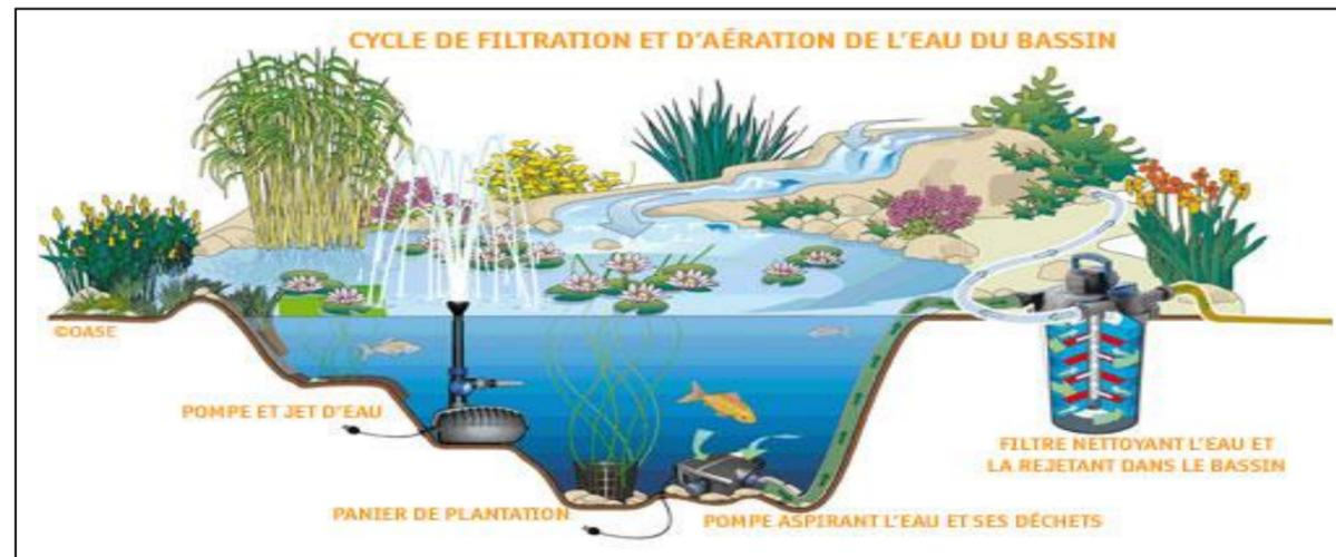
Figure 145 : Schéma de principe du fonctionnement d'un bassin; Source : Site Web ; naturbassin
