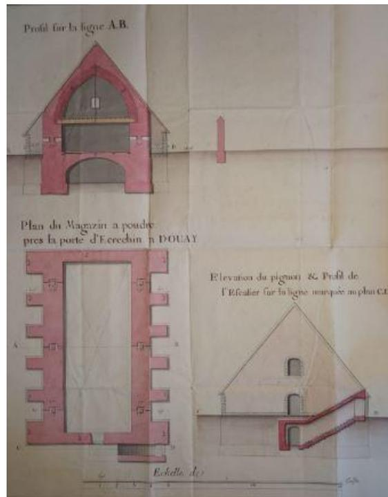
Fig 2.41 : Plan D'un Magasin avec contrefort extérieur
