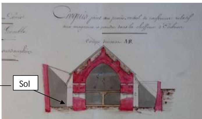
Fig 2.55 : Coupe sur la longueur D'un Magasin à poudre avec mur d'isolement
