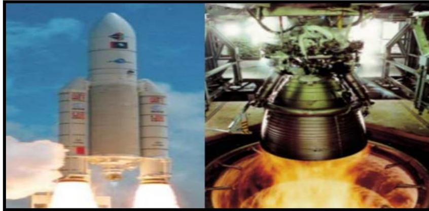
**Fig. (I.3) : Tuyère du moteur Européen Vulcain2 d'Ariane5**
