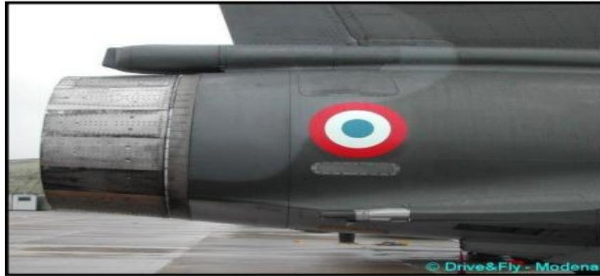
Fig. (I.9) : Tuyère à section variable.
