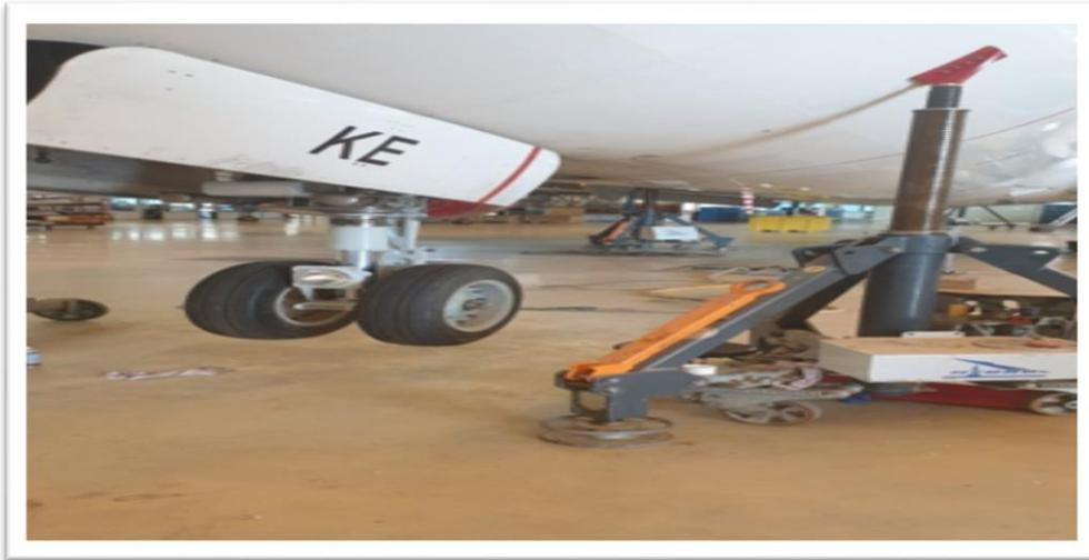
**Figure III.5 : Train d'atterrissage Boeing B737**
