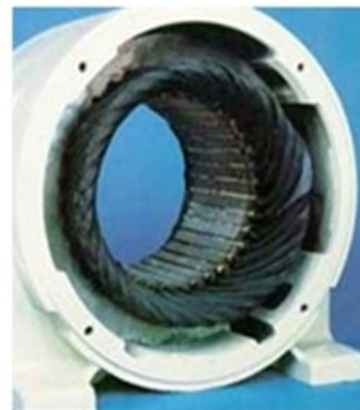
Endommagement dû à la surcharge
