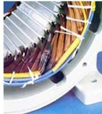
Dégradation causée par une surtension
