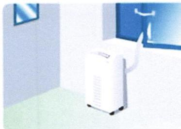
**Les climatiseurs « monobloc »** sont des produits qui ne possèdent pas d'unité extérieure. C'est par un tuyau d'évacuation à passer par la fenêtre que l'air chaud est évacué.
