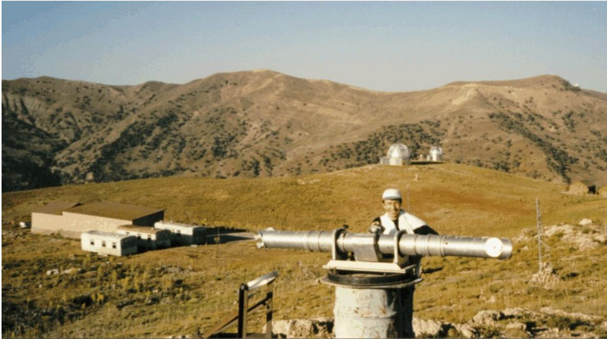
FIGURE 2.1 – *Premier instrument de mesure du mouvement d'image différentiel*
