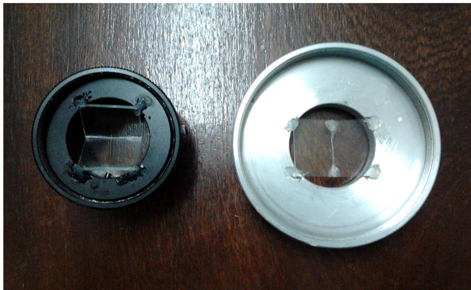
FIGURE 2.7 – Montage des lames à faces parallèles
