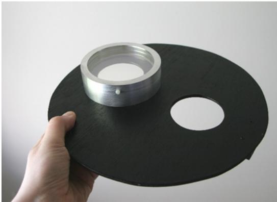
FIGURE 2.3 – Masque utilisé pour le DIMM
