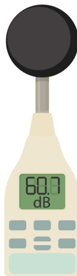
**Figure 4.8:** Sonomètre
