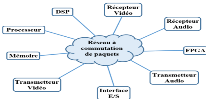
Figure 1-7: SoC basé sur l'infrastructure de communication en réseau à commutation de paquets (Chariete, 2014).
