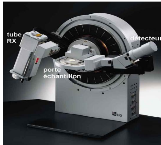
Figure 2.16 : Goniomètre de la marque Bruker-AXS type D8[93].
