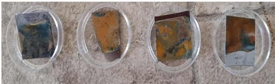
Figure 3.2 : Photo des quatre échantillons de \text{FeS}_2 préparés par bain chimique assisté par un courant de polarisation avant le procédé de sulfuration.
