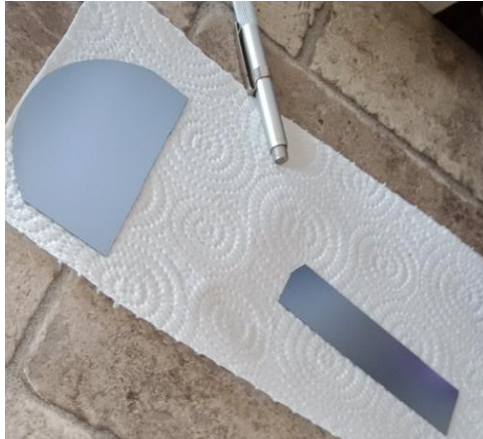
Figure 3.1 : Découpe des substrats en Si (100) par un stylé diamanté.
