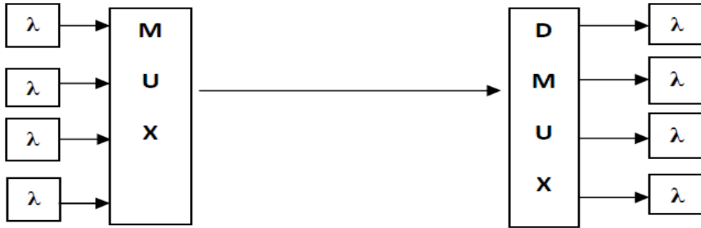
Figure 3- 14: schéma de bloc de la transmission DWDM.
