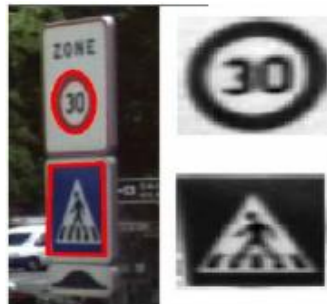
Figure 1.7 Rectification des panneaux dans le cas des fortes déformations perspectives
