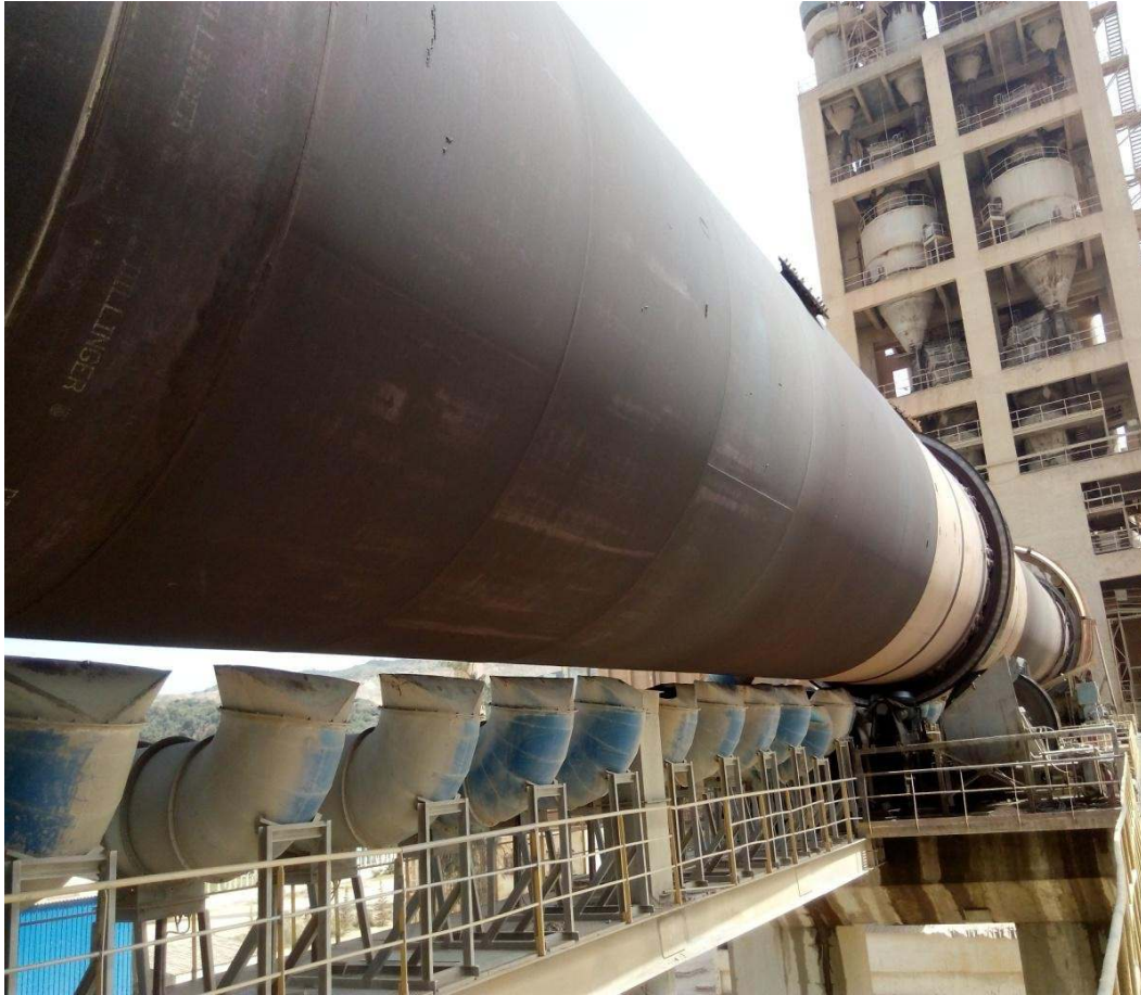
Figure 11 : Le four rotatif.
