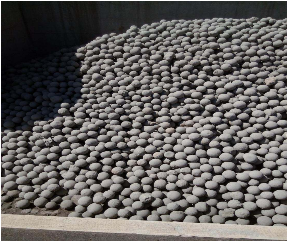
Figure4: Des boules en Fè reutilisées pour le concassage
