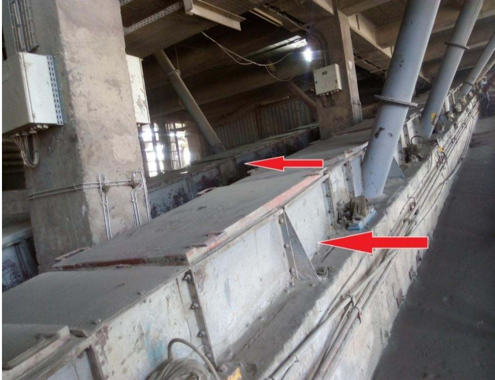
Figure 20: Les deux chaînes 24 pouces
